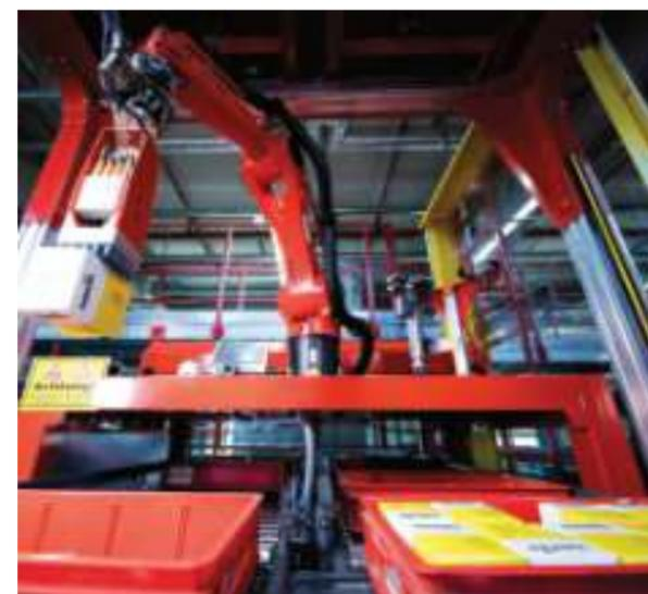
Roboterkommissionierung mit dem Pick-it-Easy Robot
