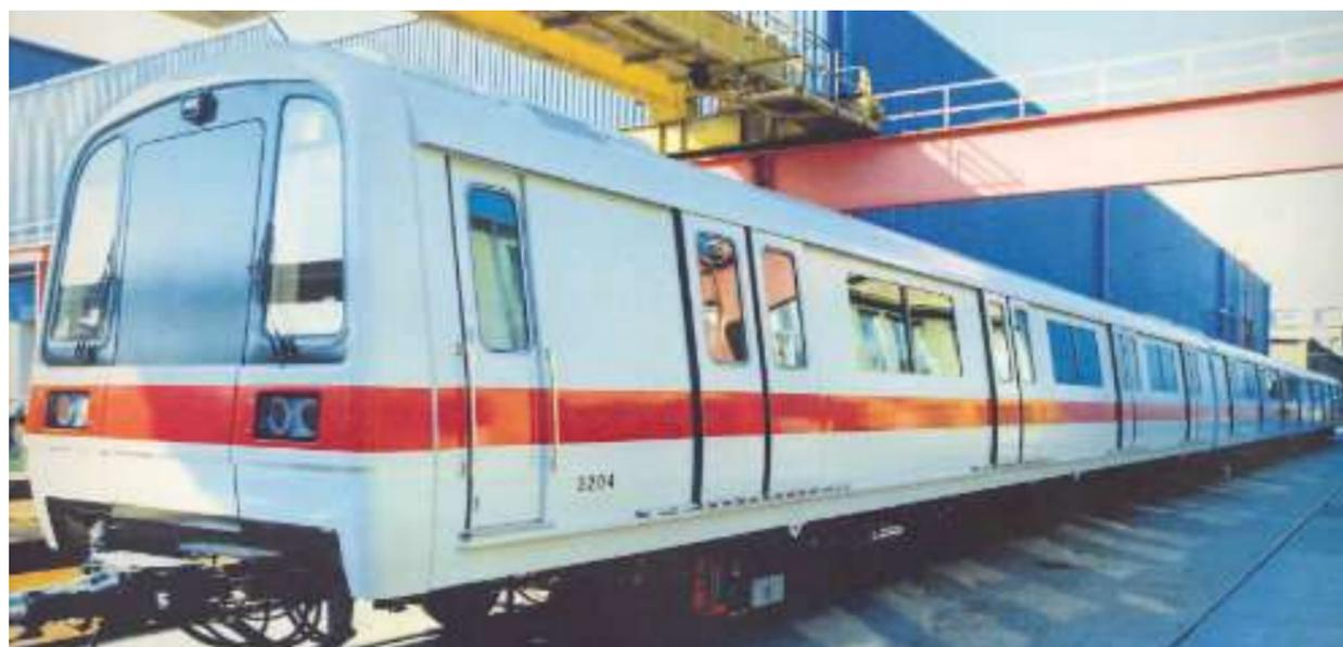
Metro Singapur: Eine Garnitur kurz vor der Auslieferung (Detail: Fensterecken sind keine Viertelkreise, sondern haben optimierte Form, sodass die Spannungen um 10% geringer werden. Dadurch werden gewichtsintensive Verstärkungen überflüssig.)
